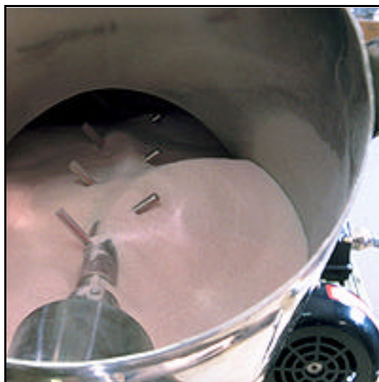
Fig. 4. Detalle de la parte interior de un mezclador en V provisto de un sistema de agitación interno mediante aspás.
