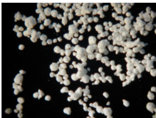
Figura 1. Fotografía de partículas esféricas obtenidas por el método de cuasi-emulsificación
