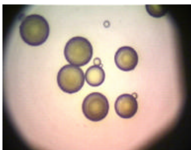
Figura 3. Microcápsulas de cipermetrina.
