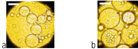
Figura 3. Fotografías de las emulsiones múltiples obtenidas con distintos diámetros para la aguja 1 : (a) 0,12 mm; (b) 0,17 mm; Barra: 5 mm.
